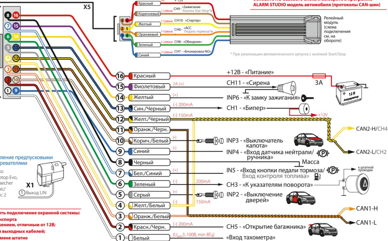
Релейный модуль (схема подключения см. на обороте)
